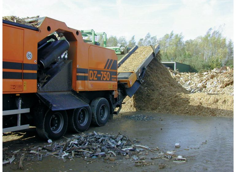
PRÉPARATION DE DÉCHETS DE BOIS EN VUE DE PRODUIRE UN COMBUSTIBLE ● SOURCE: ERBE
