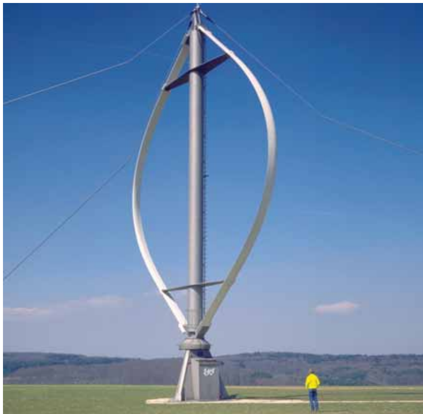
Figure 3 : Éolienne de type Darrieus de la firme Dornier © Bundesverband WindEnergie
