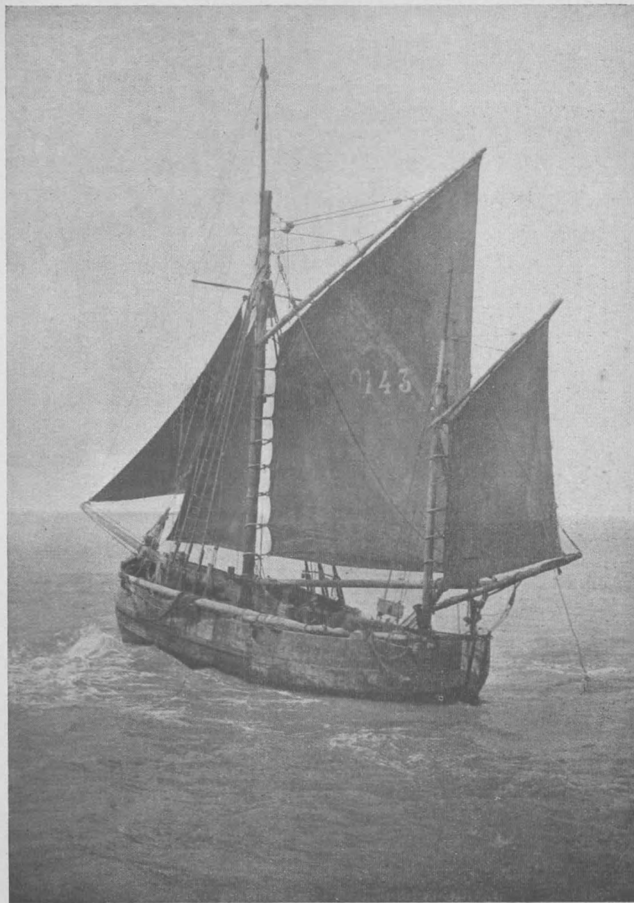
Afb. 17. — De plompe Oostendsche zeilvischsloep (dandy-cutter). Let op den korreboom aan bakboord. Dit slag van zeilschepen is sedert 'n vijftiental jaren verdwenen.
