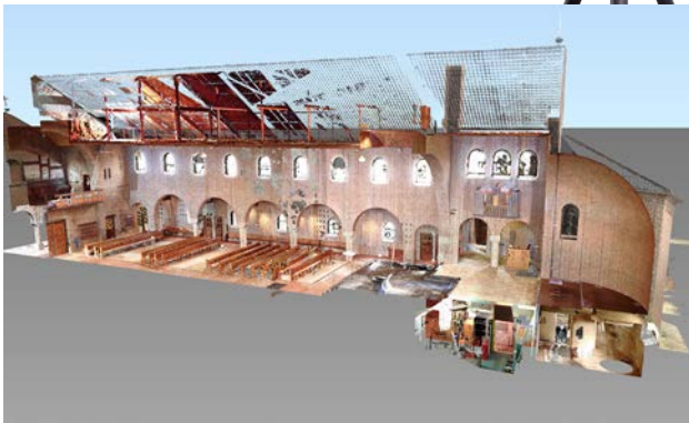
Afbeelding van een langdoorsnede van de kerk in Albergen door middel van een 3D laserscan
