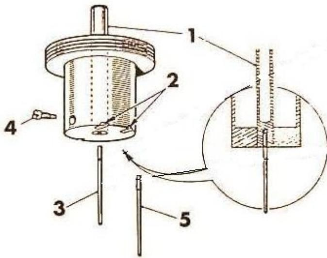
Maintenant que l'on a bien avancé. Regardons comment changer une aiguille. La cloche d'aspiration doit être démontée. Récupérer le piston avec son aiguille. Desserrer la vis 4. Enlever l'aiguille 3, la nettoyer ou en remettre une nouvelle
