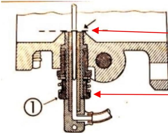
Sur cette vue en coupe vous pouvez voir ou arrive le gicleur. Il effleure bien le fond du carbu. Le faite de serrer la vis du gicleur à fond le gicleur doit se retrouver dans cette position. C'est la, aussi qu'il faut desserrer de deux tours la vis de réglage 1.
