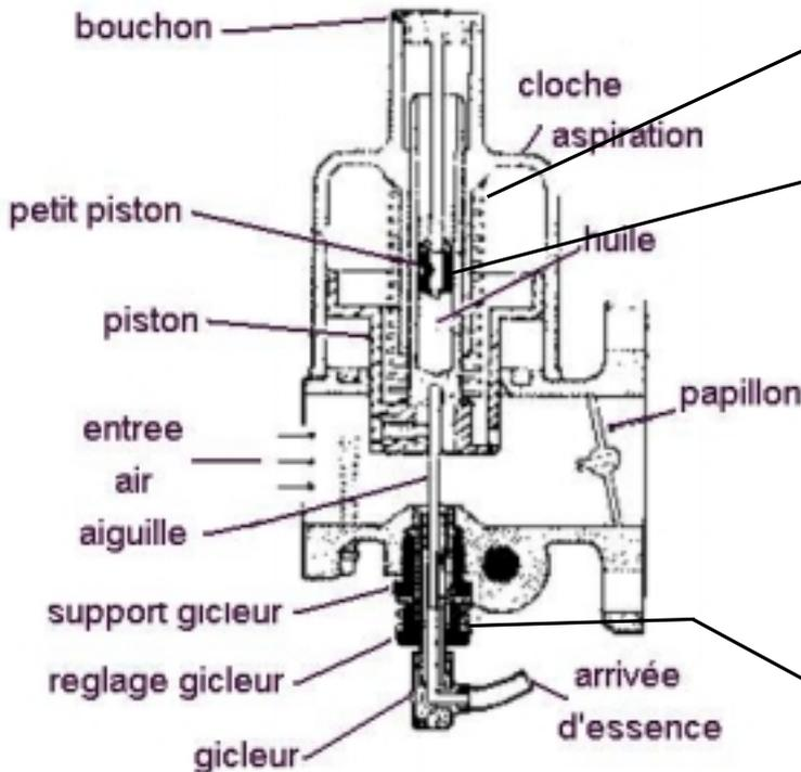
Le piston avec son aiguille à pour principe d'amortir le déplacement par l'aspiration de l'air. il se compose d'un ressort
