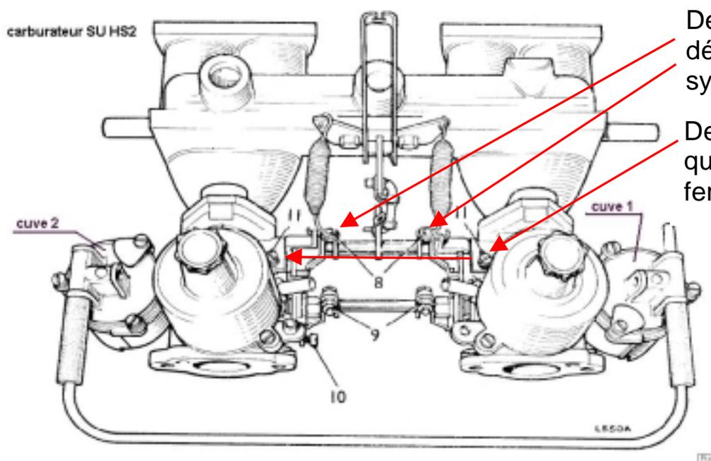
Desserrer les vis N° 8 pour désolidariser la commande synchroniser des carburateurs.
