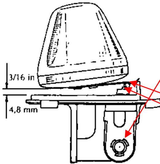
• Pour vérifier si le pointeau ferme bien mettez le flotteur à l'envers et souffler par le trou ou le tuyau d'essence est branché
