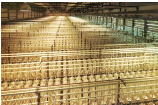
Urenco (Duitsland): installatie voor de verrijking van uranium-235
