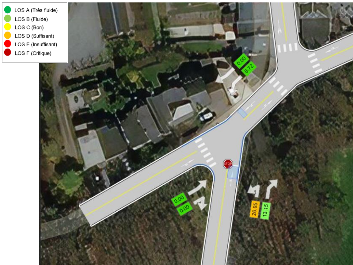
Figure 193 Temps moyens d'attentes (s) et niveau de service en heure de pointe du matin - sortie CHU (source : CSD, 2023)
