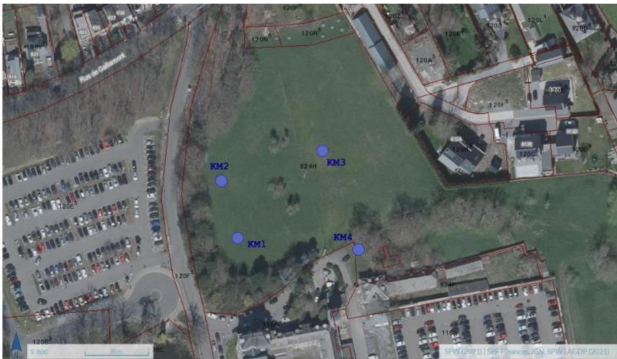
Figure 64 Répartition spatiale des essais de perméabilité (Source : Fremen, 2021)
