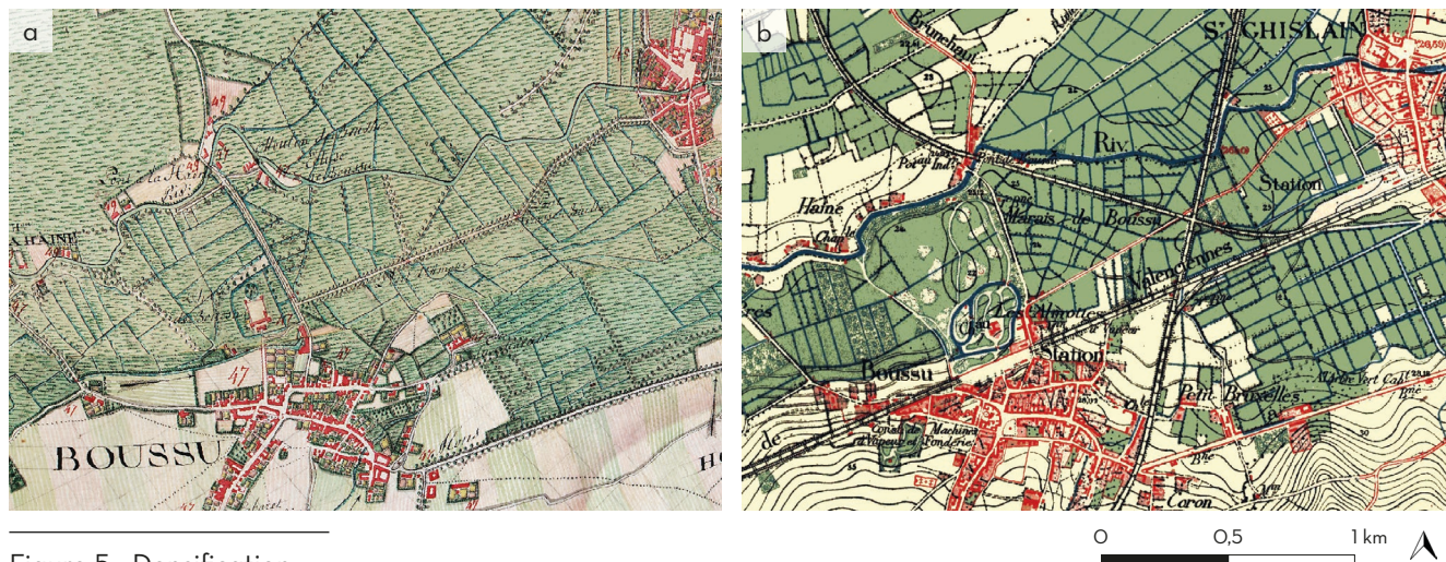
Figure 5 - Densification et extension du réseau de fossés de drainage dans la Wateringues de la Haine, entre Boussu et Saint-Ghislain (Hainaut) en un siècle. (a) 1770-78, (b) 1865-80. [Source : SPW, (a) 2010 et (b) 1865]
