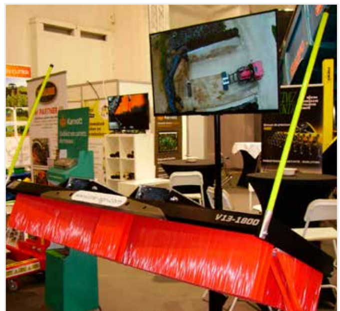
Deze veegborstel, beschikbaar in werkbreedtes van 1,5 tot 4,8 meter, zorgt voor een schone hoes-omgeving.
