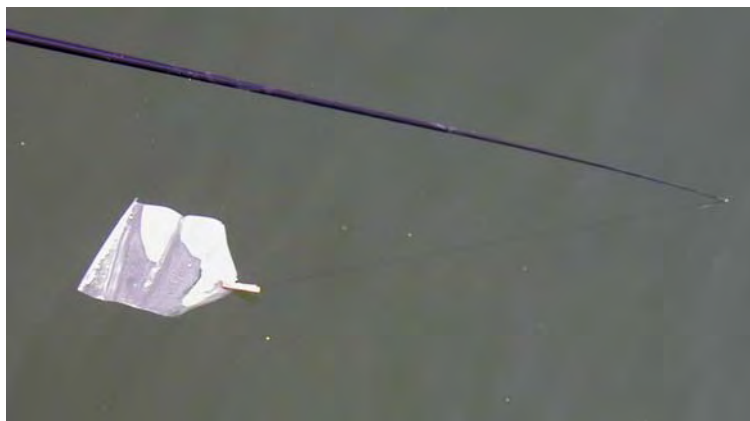
Feuille absorbante en Téflon ® sur la surface de l'eau
