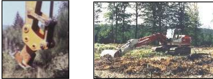
Photo 9. A droite, un arrache-souche ; à gauche, une pelle mécanique
