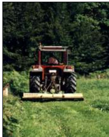
Photo 18 • S'il y a peu de matière ou si l'on ne souhaite pas récolter les résidus de fauche, il est impératif d'utiliser une faucheuse de refus.
