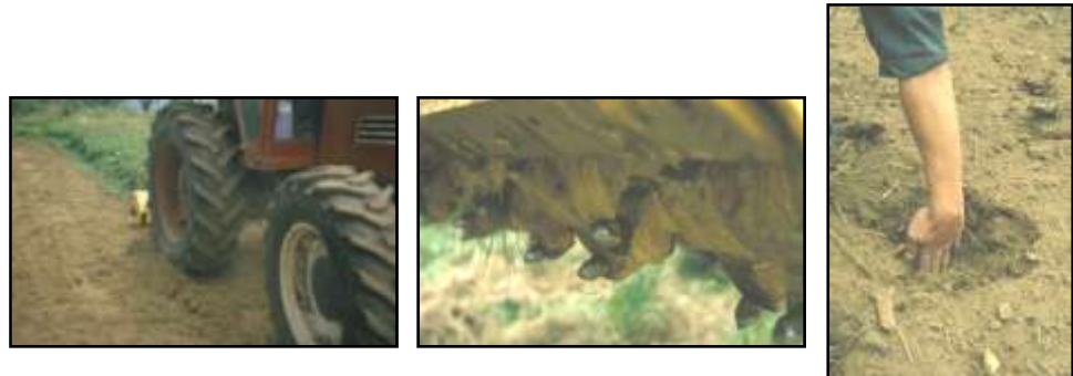
Photo 12. A gauche, le meri crusher au travail ; au milieu, les dents du meri crusher ; à droite, le sol suite au passage du meri crusher.
