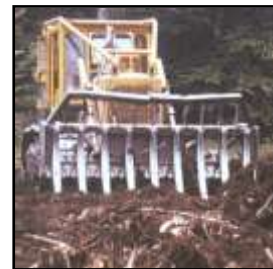
Photo 8. A gauche, lame montée sur bulldozer ; à droite, râteau andaineur
