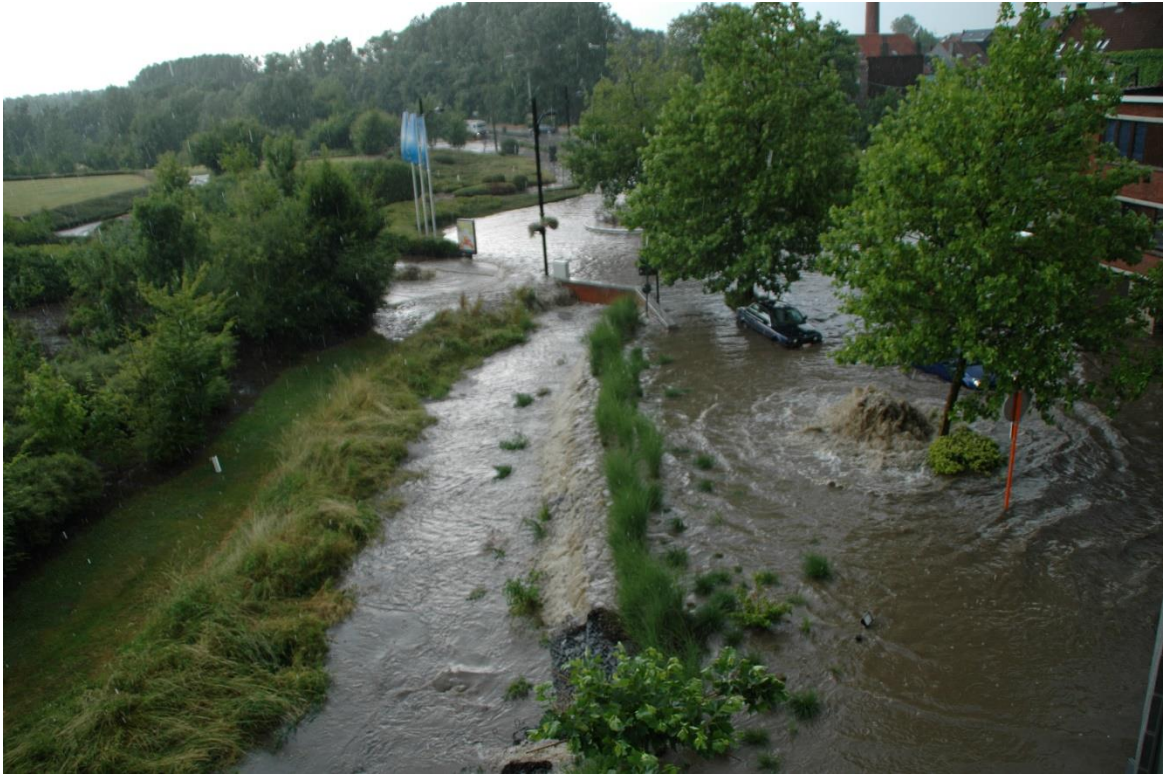
Waterloop en moerriool kunnen de afvoer van sterk verharde omgeving niet verwerken met overstromingen tot gevolg
