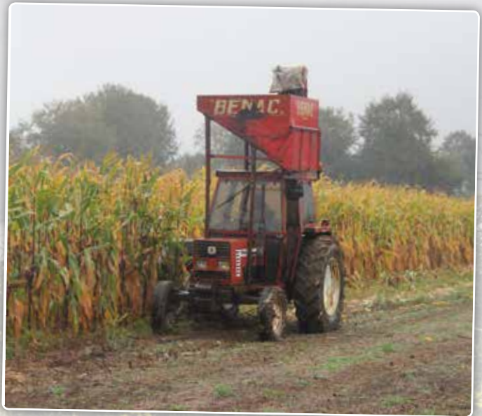
Vreemde eend in de bijt was een eenrijige gedragen maïskolvenplukker van Benac.
