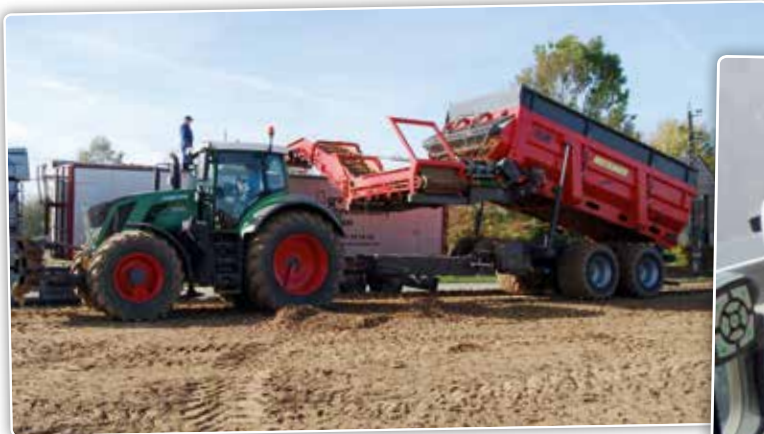
Tijdens het werk kiept de bunker omhoog en de reinigungsunit komt ter hoogte van de bestuurder.
