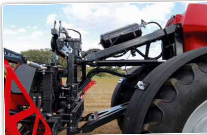
De parallellogramophanging van de spuitboom is volledig geveerd.
