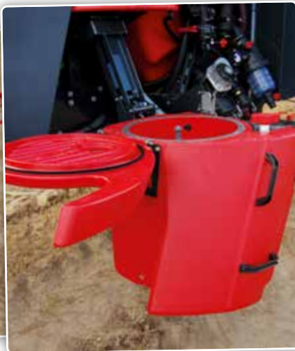
In werkstand doet het deksel van de mengtrechter ook dienst als werktafel.
