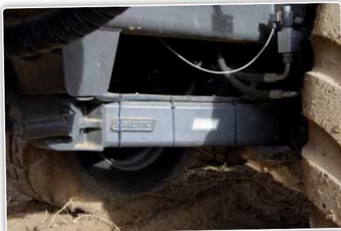
Bewezen componenten, zoals de bekende Tridac HDO-ophanging met vlakstelling, werden gebruikt waar nodig.
