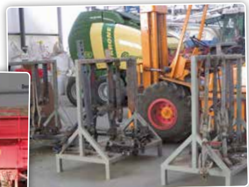
ledere trekker of machine heeft een eigen opbergruimte voor onderdelen zoals liftplaten, derde punt, enzovoort. Zo blijft alles bij die specifieke machine.
