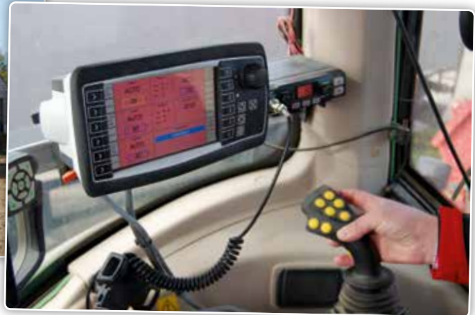
De Multiloader wordt bediend door middel van een can-bus besturing met een 7"-scherm en een multifunctionele joystick met automatische start/stop-functie.
