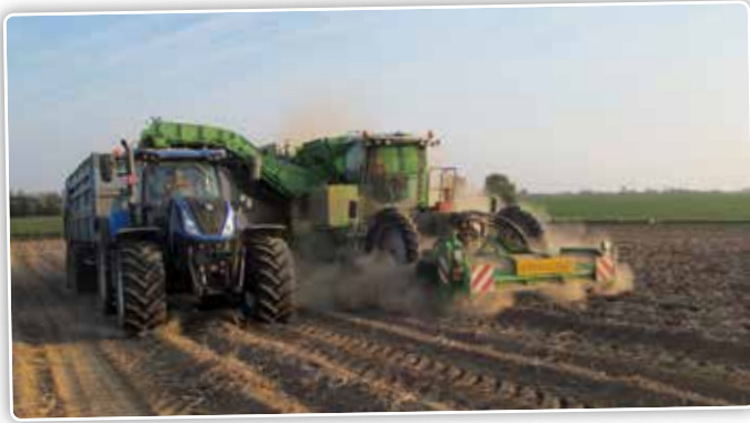
Het rooien gebeurt met eigen mechanisatie: met een 4-rijige rooier wordt circa 15 ha per dag gerooid, afhankelijk van de situatie.
