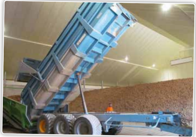
De kieper kan in de bewaarloods vlot omhoog dankzij de steile dakhelling.
