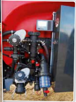
Het EasySet-kranenstelsel is vrij logisch opgebouwd en vermindert daardoor de kansen op foute bediening. Dankzij een grote, transparante zuigfilter is vervuiling vanaf de buitenkant zichtbaar.
