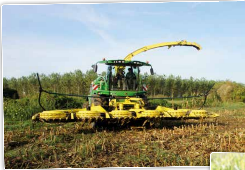
Het Kemper-voorzetstuk is speciaal voor gebruik met de nieuwe serie ontwikkeld om de capaciteit volledig te kunnen benutten.
