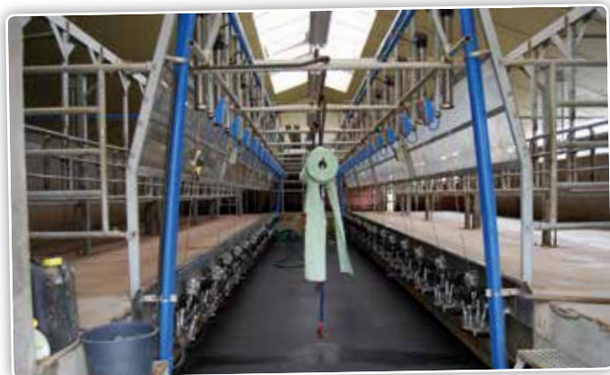
De melkstal is een 2 x 16 zij-aan-zij met rapid exit.
