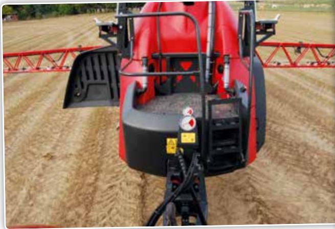
De manometer wordt nu boven de dissel geplaatst in het gezichtsveld van de bestuurder.
