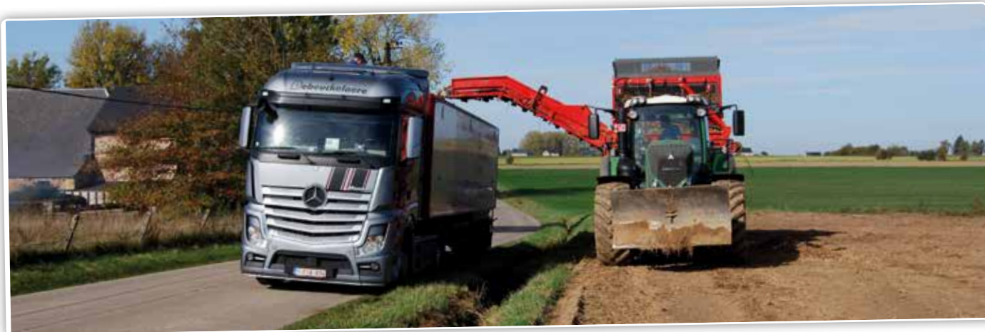
Het is mogelijk om tot 3,5 meter van de vrachtwagen te blijven tijdens het overladen: bijzonder handig als er een gracht loopt tussen het veld en de vrachtwagen!
