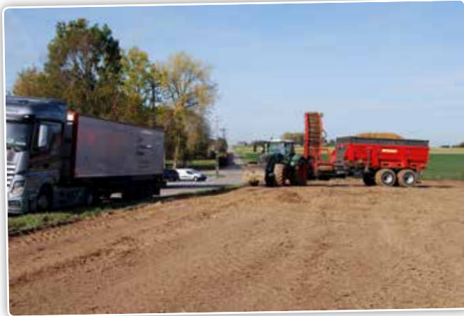
De opsteltijd is beperkt doordat het geheel op wielen rust. De combinatie rijdt tot waar het product gereinigd en overgeladen wordt.
