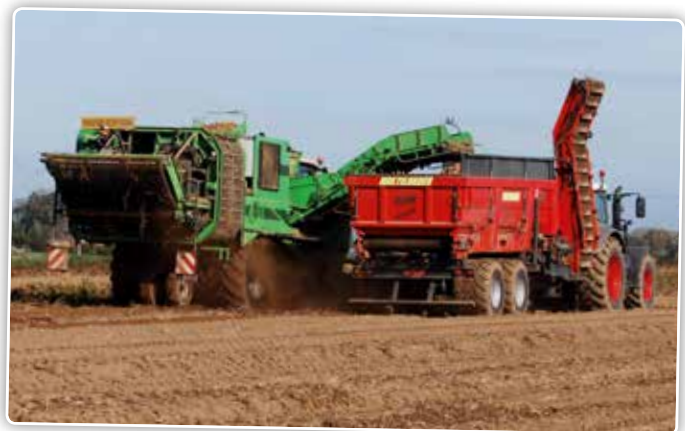
De laadcapaciteit van 22 ton komt overeen met drie volle bunkers van een 4-rijige rooier van AVR.
