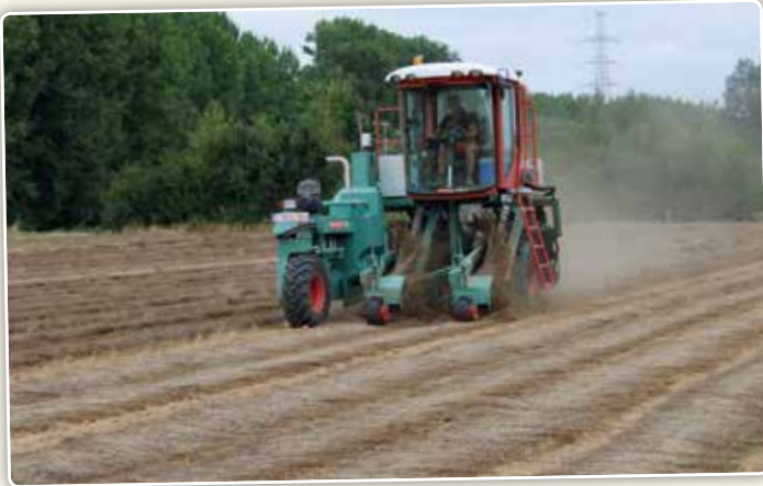
De zelfrijdende dubbele keeders zijn uitgerust met een gepatenteerd systeem voor de ononderbroken doorstroming van het vlas.
