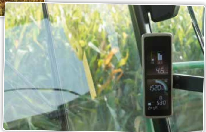
Een scherm op de stijl geeft het motortoerental en de snelheid weer.
