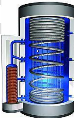
Figuur 18: Boiler met een externe thermosifonzuil
