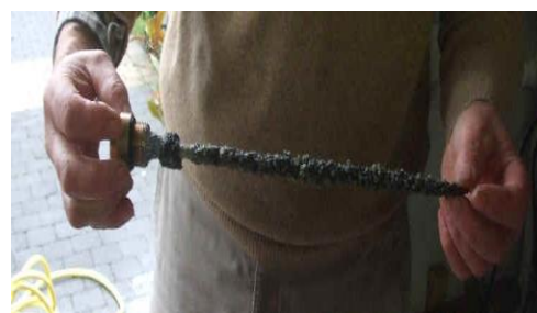
Figuur 28: Voorbeeld van een gebruikte beschermingsanode
