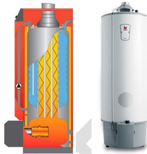
Figuur 4: gasboiler met premixbrander
